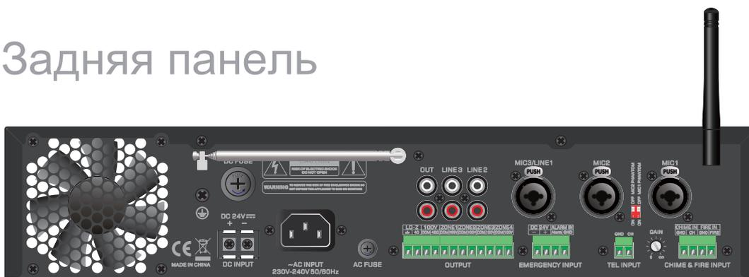
Задняя панель для обоих усилителей идентична и содержит все элементы управления подключением и настройкой (модель без «+ BT» не имеет антенны bluetooth). Элементы управления конфигурацией включают в себя настройки, которые должны быть выполнены один раз при настройке системы и не должны быть изменены пользователем впоследствии.
