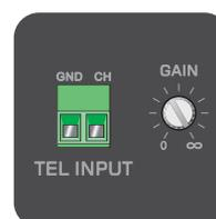
Аварийный вход (клеммная колодка):
